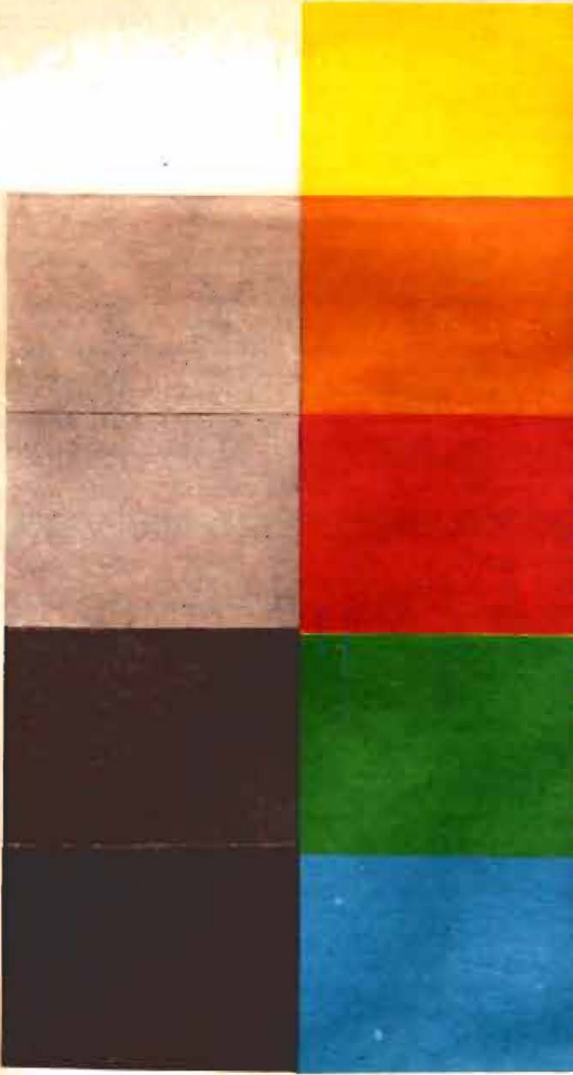
Figura 1 redă o scală gri de control cu opt cîmpuri, din care unul alb și unul negru.
